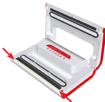
Schéma 3 : Collez le ruban Status Stiki sous la bande d'étanchéité.
